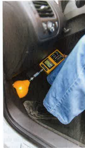
Unterschiedliche Messpunkte: Im Fussraum des Fahrers wurden die zweithöchsten Werte gemessen
