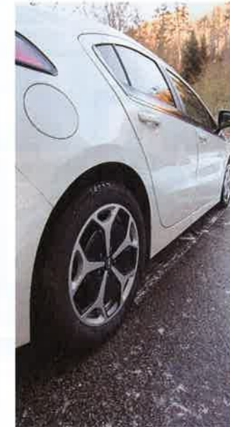
Ursache Reifen: Der magnetisierte Stahlgürtel des Hinterrifens verursacht die hohe Belastung auf dem Rücksitz
