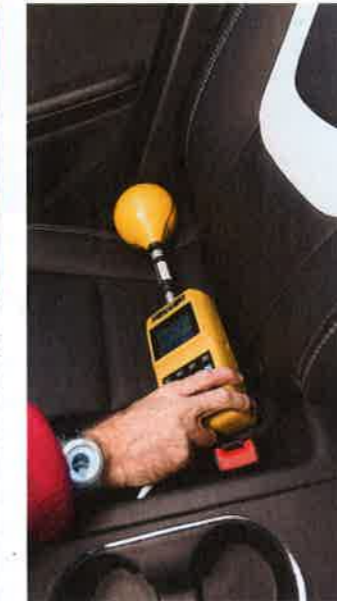
Ursache Reifen: Der magnetisierte Stahlgürtel des Hinterrifens verursacht die hohe Belastung auf dem Rücksitz
